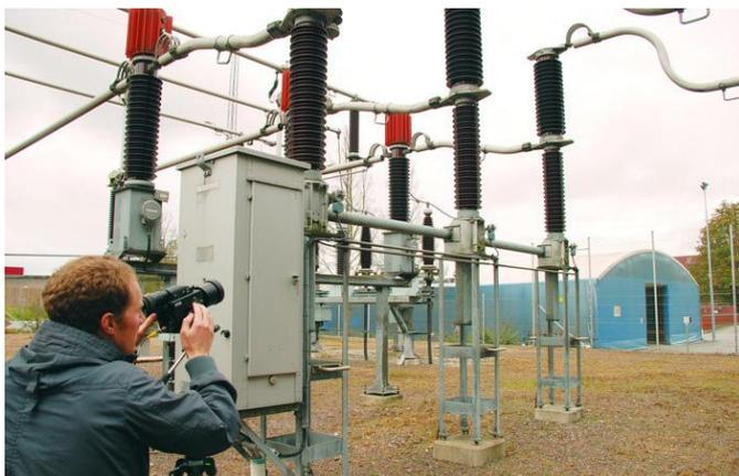
Инфракрасное тепловидение предоставляет возможность наблюдения тепловых излучений, что позволяет предотвратить проблемы перегрева, вызванного большим сопротивлением или излишне высоким током, еще до того, как они наступят. Это нормальное явление: когда ток проходит по электрическому контуру, небольшая часть электроэнергии претерпевает превращение в тепловую. Но при
